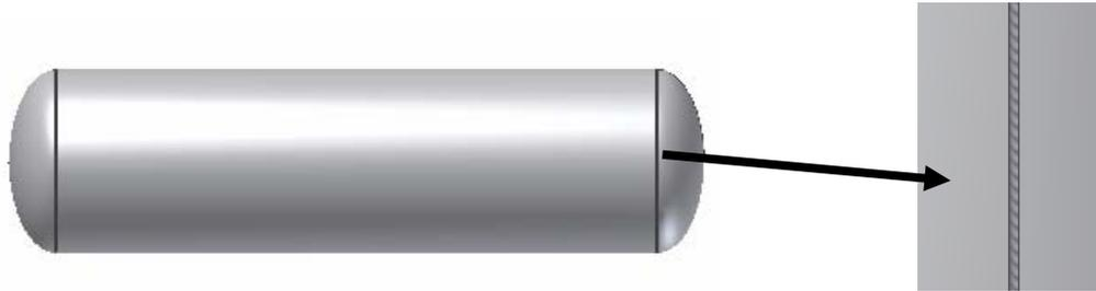
**Figura 4.10** Cordón de soldadura entre el casco y los cabezales del separador.
