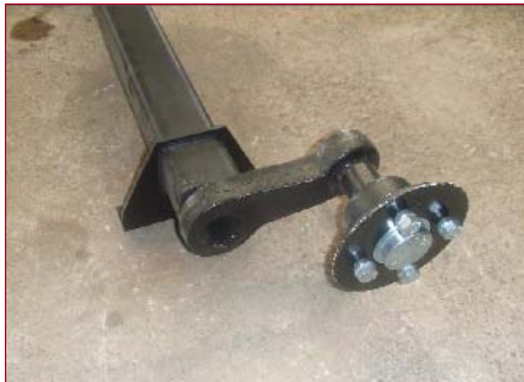
Figura 4.15. Sistema de eje sin freno para remolque de 550 kg. [18].
