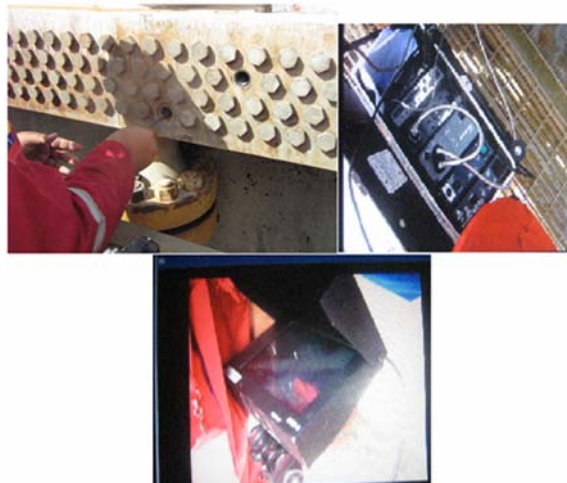
Figura 3.1. Videoscopio utilizado para realizar la inspección termográfica.
