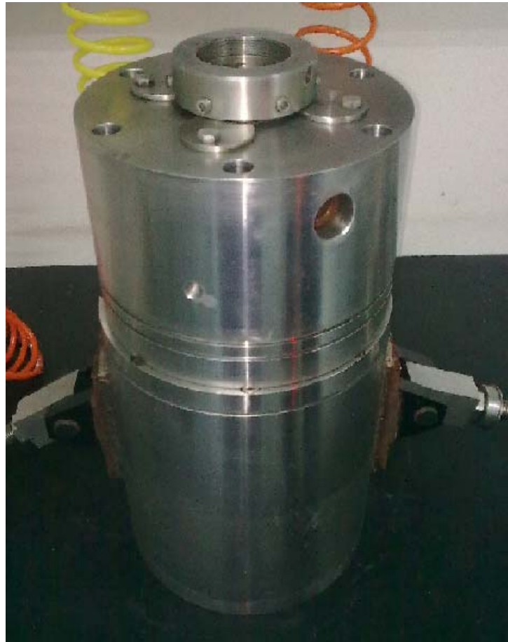
Figura 5.4 Sello Mecánico en el banco de prueba.
