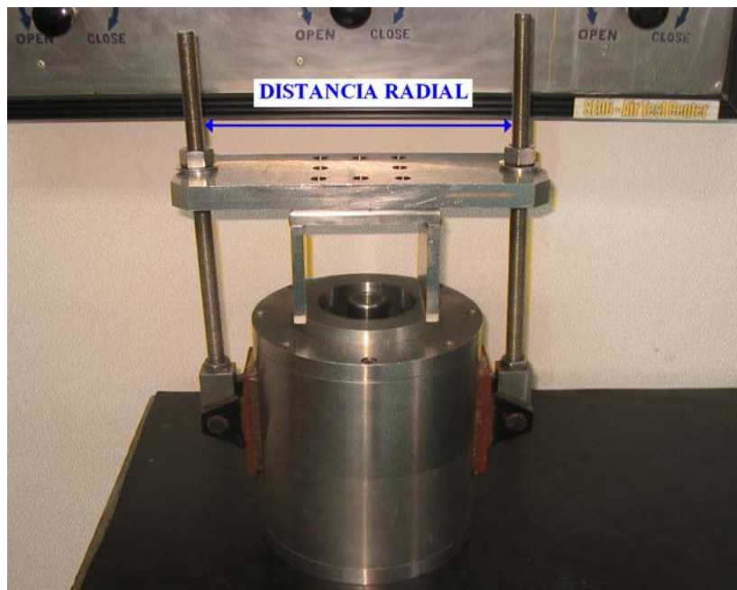
Figura 4.1 Banco para Realizar Pruebas Neumáticas a Sellos Mecánicos.
