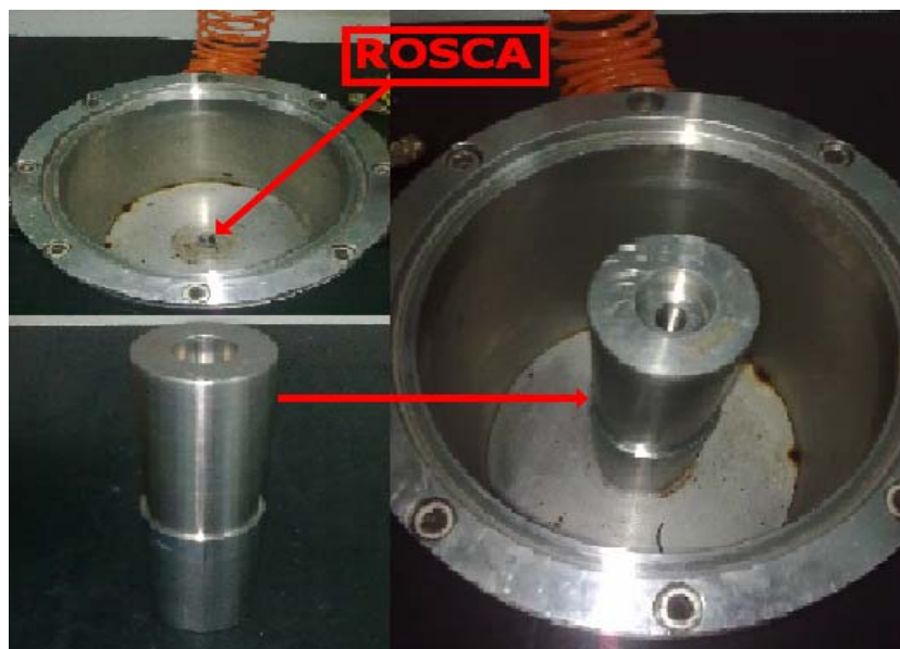
Figura 5.2 Accesorio del banco de prueba que simula el eje de la bomba.
