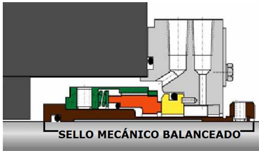
Figura 2.17. Sello mecánico balanceado [1].
