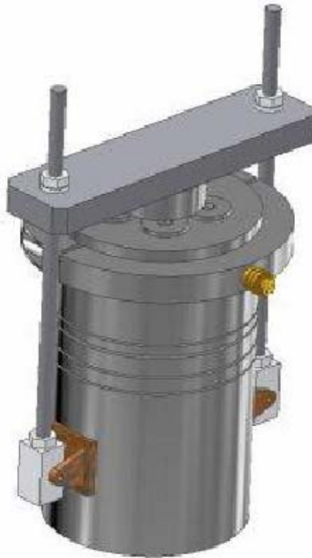
Figura 5.8 Acople en el sello mecánico montado en el banco de prueba.
