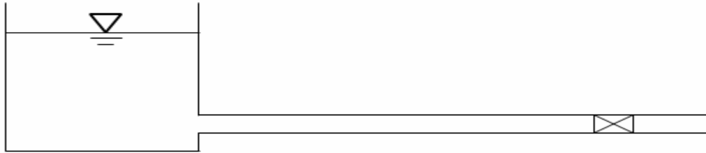
Figura 3.3 Sistema Reservorio – Tubería- Válvula.
