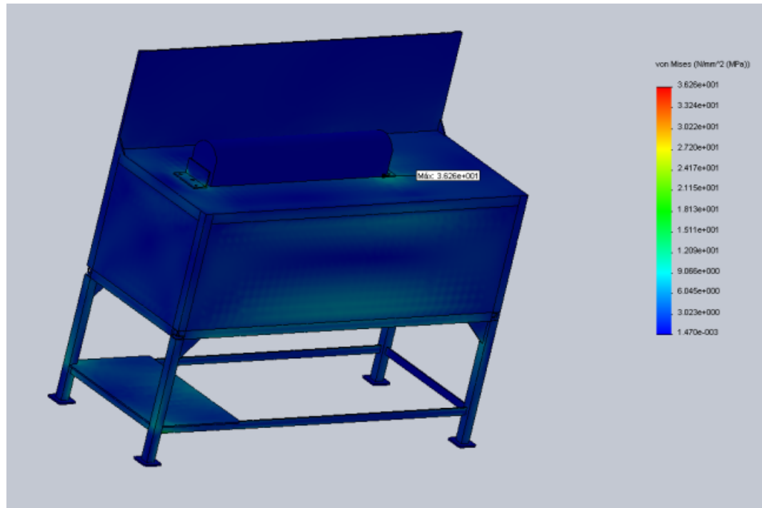
Figura 4.20. Generación de esfuerzos de Von mises
