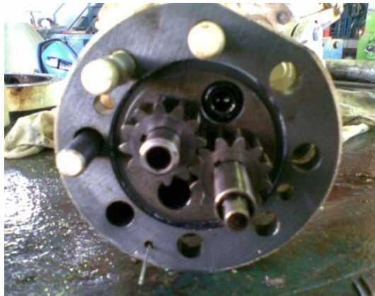
Figura 4.10. Vista de los elementos bombeadores del divisor de flujo.
