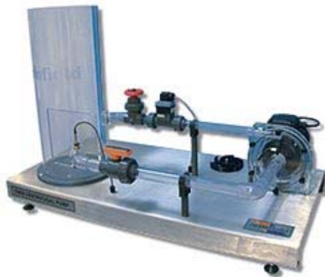
Fig. 2.1. Banco de pruebas de bomba centrífuga FM 20 ubicado en el Laboratorio de Termodinámica de la Universidad de Oriente. [Fuente: catálogo de equipos Armfield]
