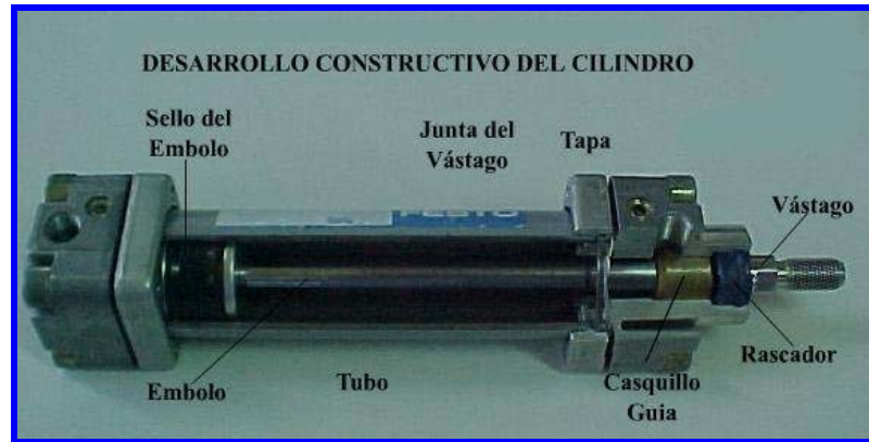
Figura N°2.2. Modelo de un cilindro neumático.[Fuente: 6]
