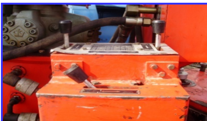
Figura N°4.31. Válvulas neumáticas (china). [Fuente propia]
