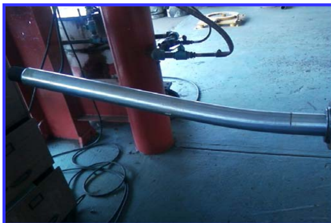
Figura N° 4.6. Vástago doblado de la llave hidráulica. [Fuente PDVSA]
