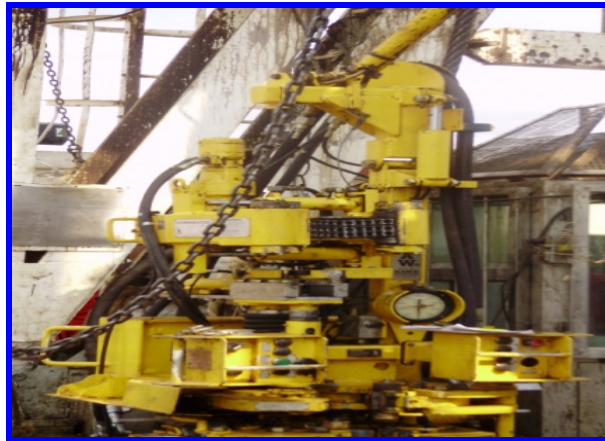
Figura N° 2.1. Llave hidráulica. [Fuente: Propia]
