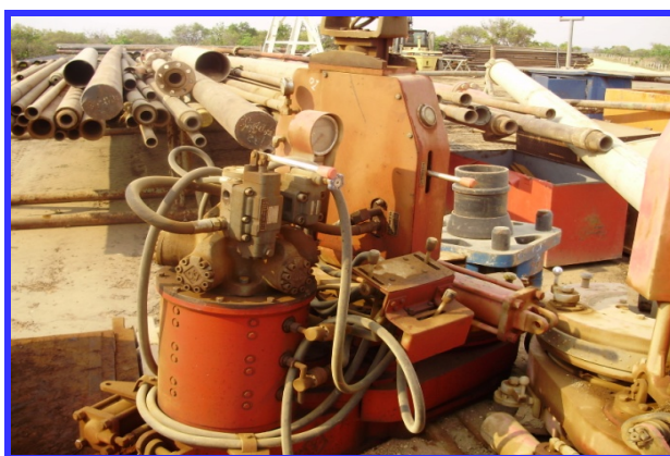
Figura N° 4.5. Llave hidráulica modelo ZQ203-100II. [Fuente propia]
