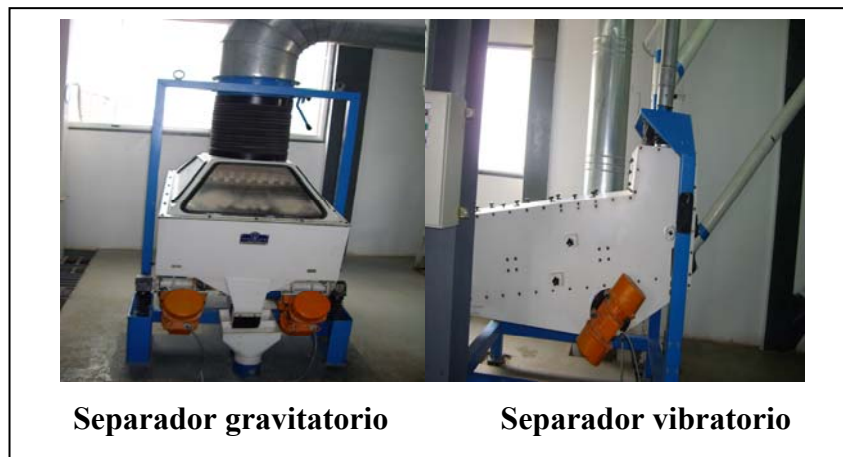
Figura 4.1: Separadores de impurezas utilizados en la sección de limpieza. Fuente: Planta Procesadora de Maíz “Chaguaramas” (2010).
