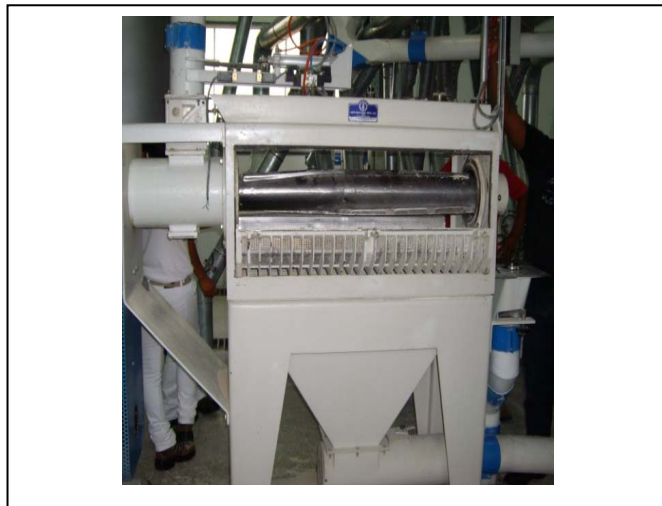
Figura 4.3: Sección transversal derecha del pulidor. Fuente: Planta Procesadora de Maíz “Chaguaramas” (2010).
