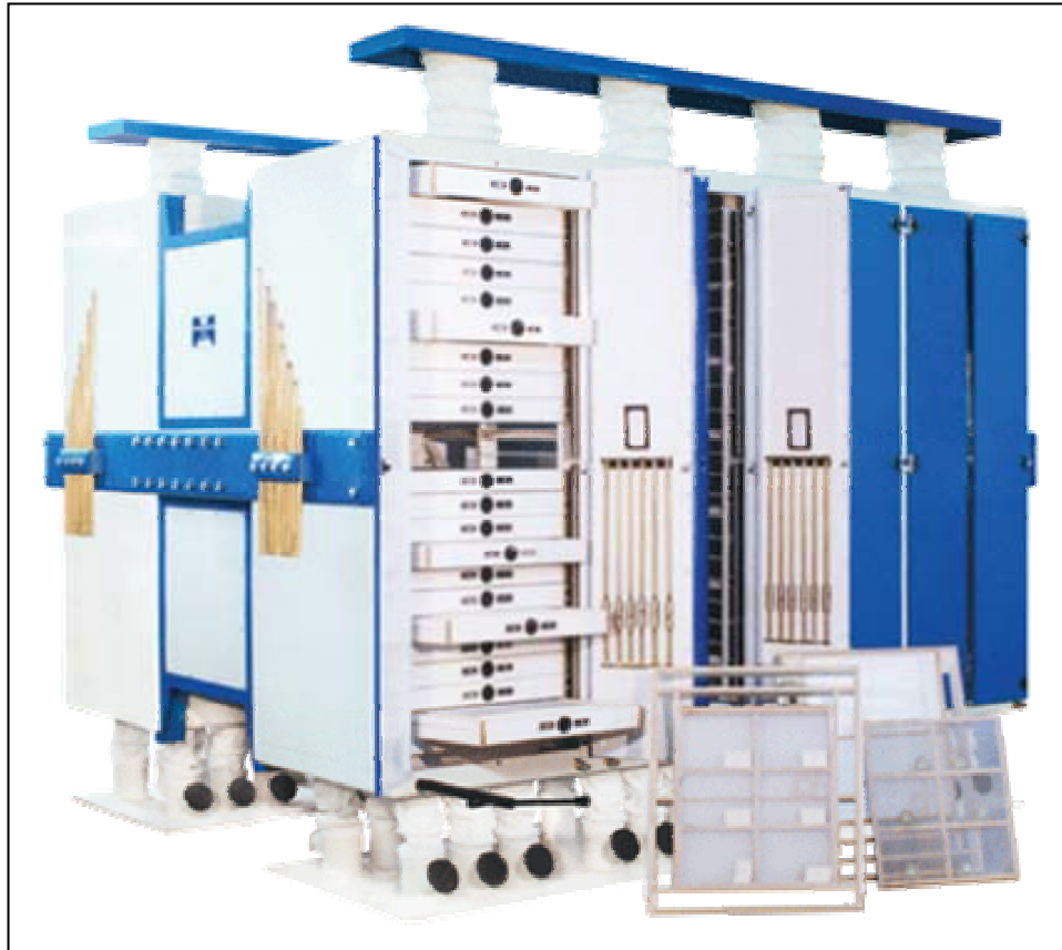
Figura 4.7: Cernedor o Plansifter. Fuente: ARD MACHINE. Página web (2010).
