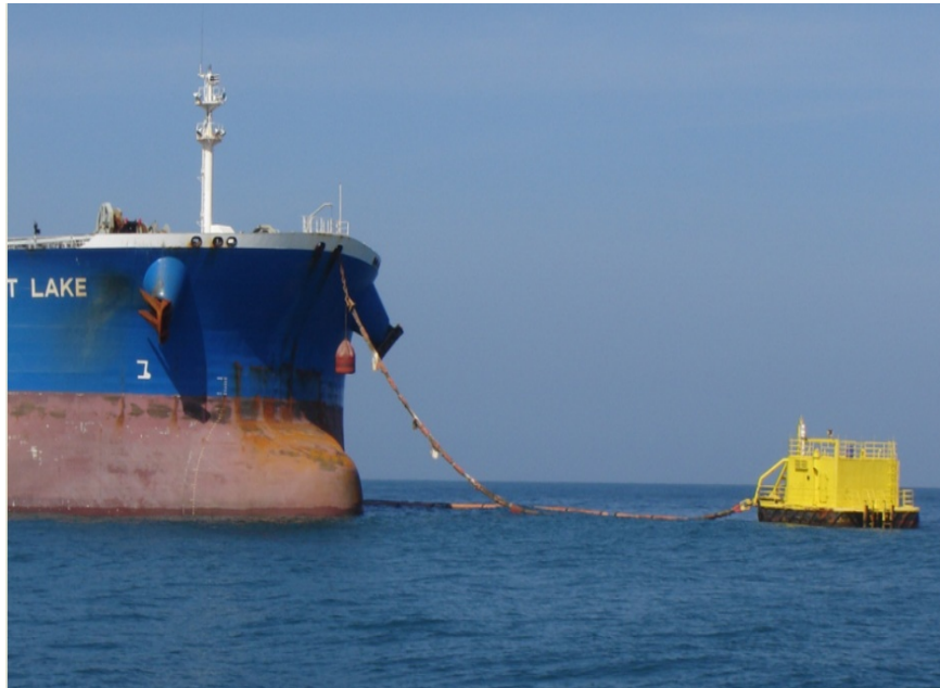
Figura 2.6. Transferencia de crudo Merey 16 API desde la Monoboya del TOJ hacia un buque.
