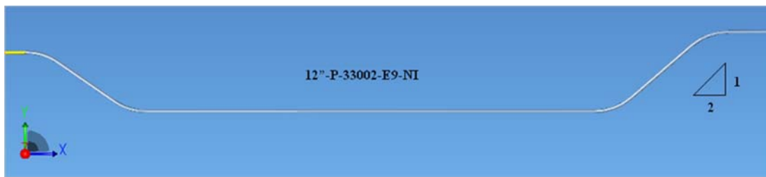
Figura 3.3.1 - Bayoneta típica para pasos de ríos y vías
