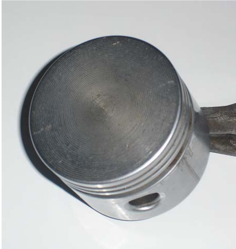
Figura B1. Pistón de un Motor de Combustión Interna Alternativo (MCIA), con las características del modelo computacional.
