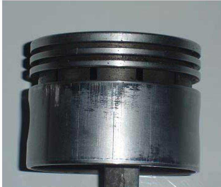
Figura B2. Pistón de un Motor de Combustión Interna Alternativo (MCI), con las características del modelo computacional.
