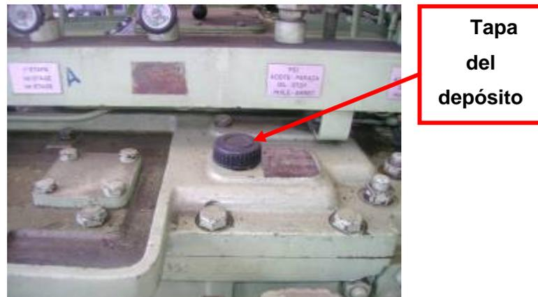
**Figura 4. 9: Tapa del Depósito de Aceite o Carter donde se debe obtener la muestra. [Fuente: Propia]**
