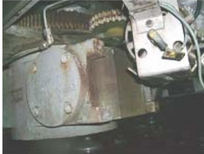
**Figura 4.13: Reductor de la Tapadora de Botellas. [Fuente: Propia]**
