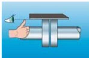
**Figura 4. 5: Método utilizado para alinear los ejes en la planta.**
