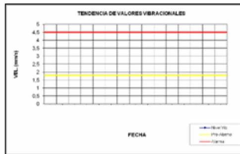
Figura 3.19: Ejemplo de Gráfico de tendencia de las vibraciones en los equipos en unidades de velocidad. [Fuente: Propia]
