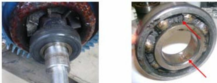
**Figura 4. 3: a) Estado del Rodamiento del lado motriz del conjunto motor – bomba del tanque buffer al retirarlo del motor, b) Rodamiento del lado motriz del conjunto motor – bomba del tanque buffer sin la tapa selladora.**
