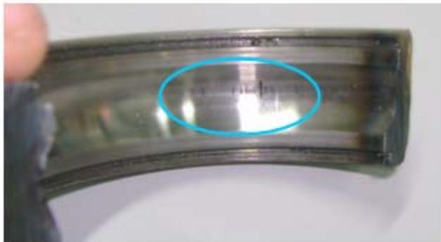
**Figura 4. 8: Pista externa del rodamiento de la bancada de la bomba.**
