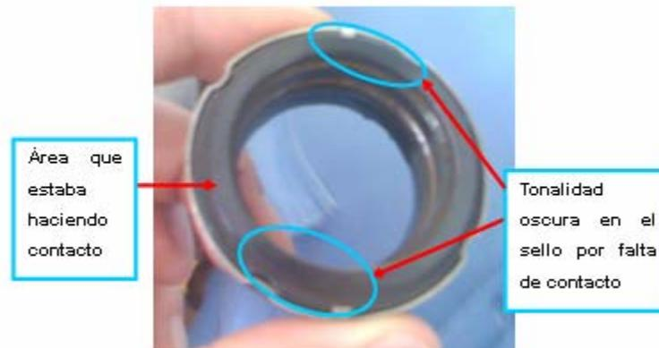
**Figura 4. 7: Huella de desgaste no uniforme en la cara rotativa del sello. [Fuente: Propia]**
