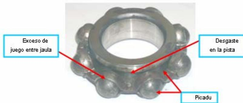
**Figura 4. 4: Pista Interior, Jaula y Bolas del rodamiento de la bancada del equipo (REFRI-AH-B01). [Fuente: Propia]**
