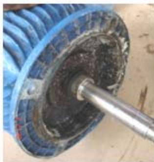
**Figura 4. 2: Lado motriz de la bomba con restos de jarabe simple solidificado (azúcar) fuente de desgaste en los componentes mecánicos.
