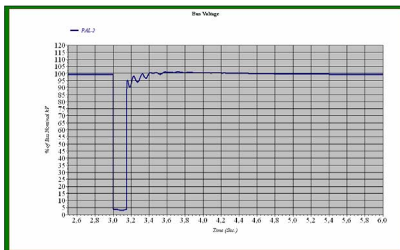
Figura 4.1. Respuesta del voltaje en la barra de la S/E PAL. Escenario 1a.
