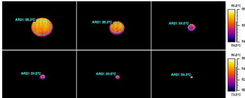
Figura 3.18 Lecturas de temperatura de un cuerpo negro a +85^{\circ}\text{C} ( +185^{\circ}\text{F} ) con distancias cada vez mayores.
