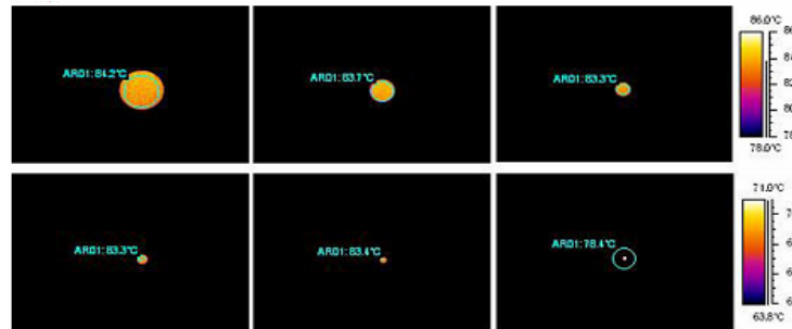
Figura 3.19 Lecturas de temperatura de un cuerpo negro a +85°C (+185°F) con distancias cada vez mayores (lente de 24°).
